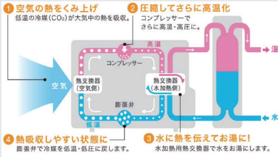
エコキュートは、電気エネルギーを使って、空気の熱をくみ上げ、給湯エネルギーを得ることができます。つまり電気エネルギーだけでお湯をわかすのに比べ、消費電力は約 1/3 に低減し、とても経済的です。
